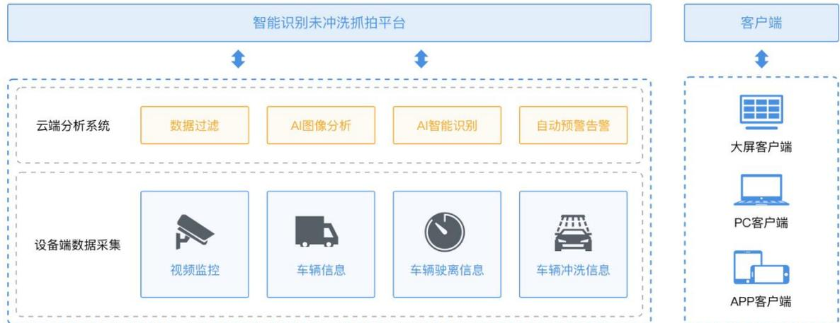
**系统工作原理：**将 AI 摄像头的设备号添加至设备平台中（即与平台对接）。通过摄像头进行车辆冲洗区域划分，一个摄像头对准冲洗区，一个摄像头对准绕行区，配置摄像头参数属性并保存。当冲洗区域内有车辆出现后，摄像头开始工作，进行车辆拍摄识别，并且开始工作记录现场情况，车辆停留在冲洗区域并冲洗规定的时间后开出冲洗区域，则判定本次车辆冲洗为‘合格’，并记录在设备平台中，若在冲洗区域中未待满对应设置的时间就离开，则判定此次车辆冲洗‘失败’，并记录在设备平台中。若车辆在绕行区域内则判定此次车辆冲洗‘失败’。
